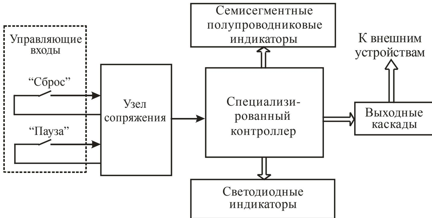
Рисунок 3.1 – Обобщенная функциональная схема прибора
